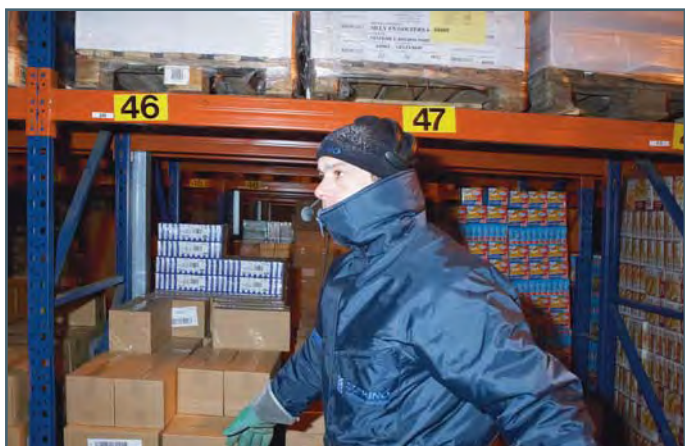
Les préparateurs reçoivent les ordres de commandes directement par le casque, la voix leur indiquant le chemin pour récupérer le colis.
