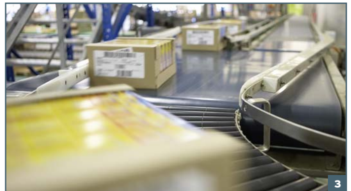
Les colis sont transférés via des rampes pour la préparation des palettes par client
